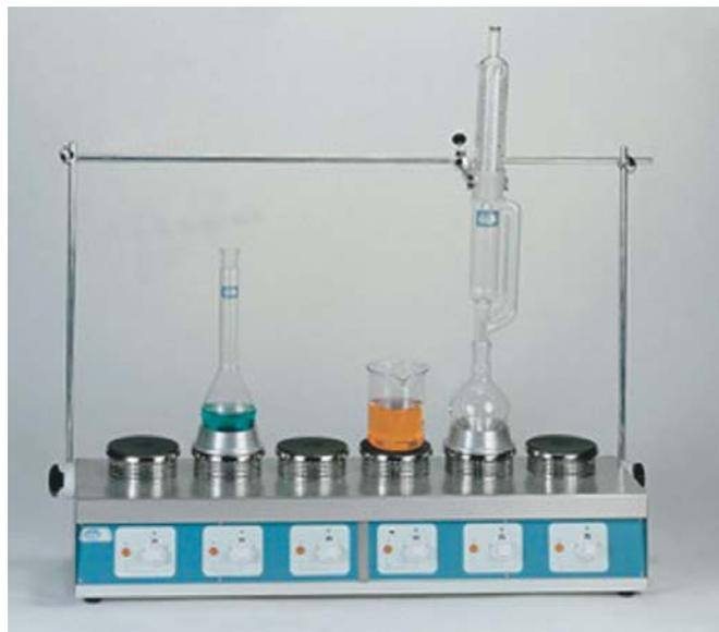
Баня из нерж. стали AISI 304 140 мм в диаметре и 75 мм в высоту, крышка с концентрическими редуцированными кольцами, может заполняться водой, маслом, песком. Кат. № 11.14B003.
