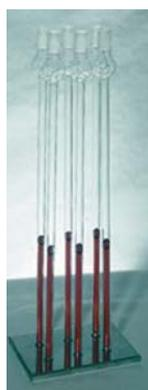
Подставка для пробирок из химически стойкого дюралюминия, с боковыми ручками и съемными панелями, что обеспечивает нагрев вокруг пробирок и позволяет видеть пробы в процессе.
