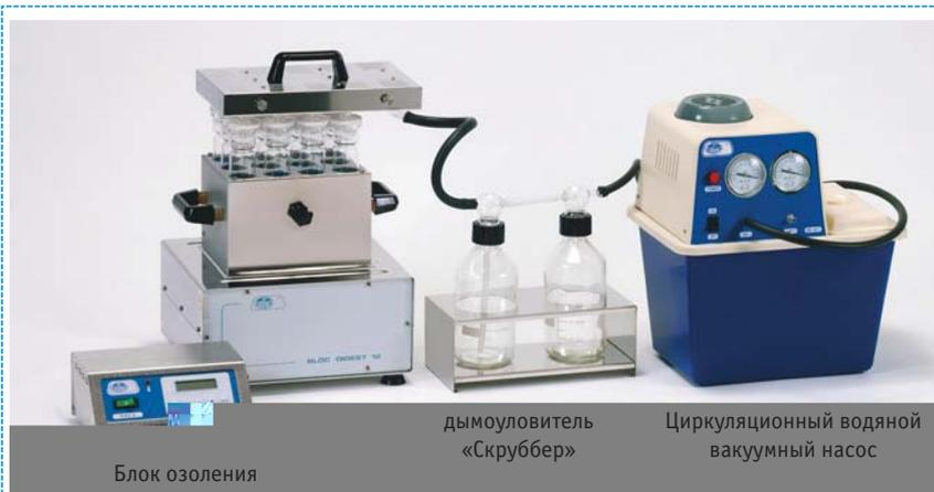
Снижает расход воды, не требует постоянного подключения к водопроводу. Позволяет избежать попадания паров и кислотных растворов в слив. Низкий уровень шума (65 дБ). Циркуляционный насос изготовлен из химически стойких материалов.
