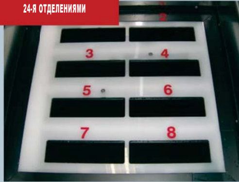
Отделения для индивидуальной заморозки пакетов и ампул с кровью
