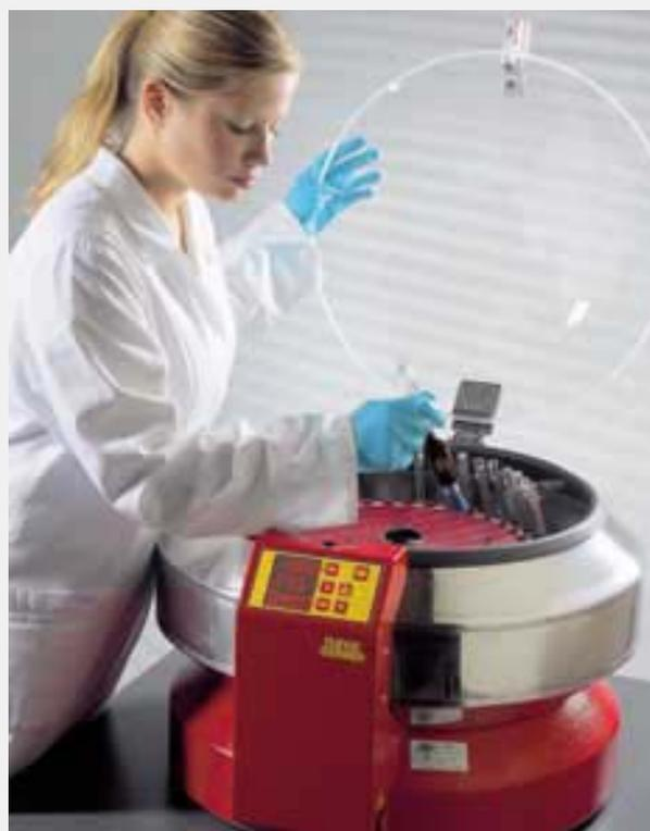
Рис. 4 Крышка центрифуги должна быть снабжена блокировочным механизмом. По истечении установленного времени центрифугирования автоматически начинается торможение ротора.
