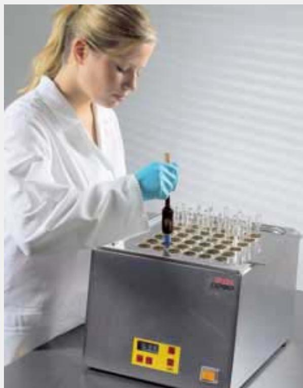
Рис. 5 Жиромеры доводятся до точно определенной температуры на водяной бане.
