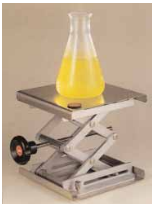
Лабораторный стол-домкрат "Пантограф". Материал-нержавеющая сталь.
