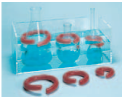
Изготовлены из нержавеющей стали покрытой высокопрочным полимером. Предназначены для надевания на различные колбы (конические, волнометрические, Эйренмейера и т.д.) и удерживания их в водяных банях, ультразвуковых мойках и т.д. Предотвращают всплытие колб благодаря увеличению их веса за счет надевания "весового" кольца. Два типа - цельные и с разрывом. Предлагается металлическая пирамида для хранения колец.
