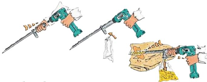
т. п. пробы, отбирающиеся из пакетов, мешков, контейнеров и грузовых машин должны быть представительными для получения достоверных результатов. Этого можно добиться использованием стального зонда-пробоотборника "ENDLESS" производства International Pbi, действие которого основано на принципе Архимеда. Зонд с внутренним спиральным буром работает от аккумулятора. Проткните стенку мешка заостренным
