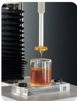
НАСАДКА ДЛЯ ОБРАТНОЙ ЭКСТРУЗИИ А/ВЕ
