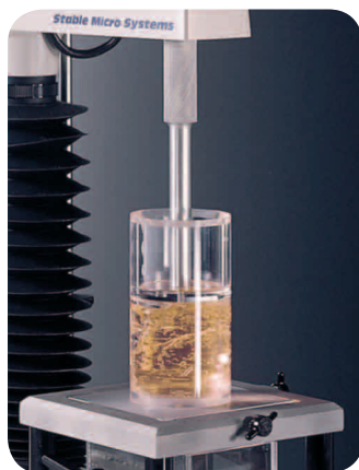
НАСАДКА ДЛЯ ПРЯМОЙ ЭКСТРУЗИИ НДР/FE
