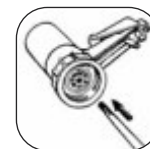
Надежно соедините погружную трубку с насосом
