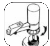
Навинтите корпус насоса на контейнер
