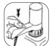
Откройте клапан и перелейте жидкость
