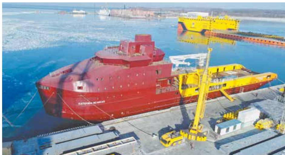
Спуск на воду судна снабжения «Катерина Великая» означает завершение стапельного этапа постройки
